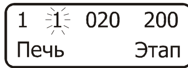
Рисунок 6 – Вид цифрового табло пульта при установке номера этапа
