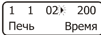
Рисунок 7 – Вид цифрового табло пульта при установке длительности этапа
