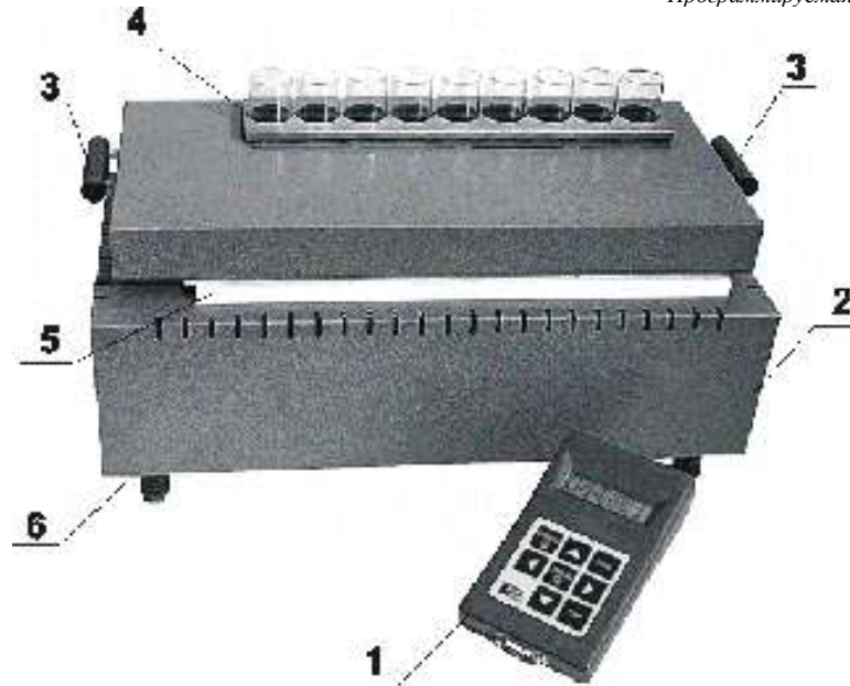
1 – пульт управления; 2 – двухкамерная печь; 3 – ручки для открытия/закрытия камеры озоления; 4 - камера выпаривания; 5 - камера озоления; 6 – сетевой выключатель
