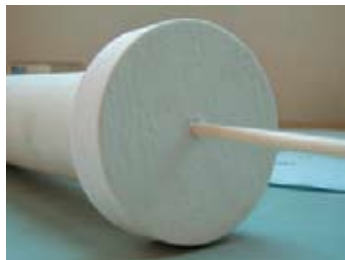
Пакет подачи газа 1: Волокнистая пробка с подключением защитного газа, подходит для многих случаев лабораторного применения
