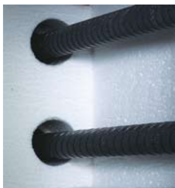
Пространство печи с высококачественным волокнистым материалом и нагревательными стержнями из карбида кремния на сторонах печи
