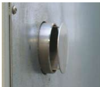
Отверстие выходящего воздуха в задней стенке для отвода возникающих при сушке газов
