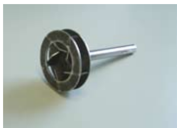
Рабочее колесо вентилятора в задней стенке печи
