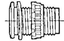
Соединительный узел для монтажа на ёмкость, внешняя резьба, в комплекте с уплотнениями из ЭПДМ. Предназначен для упрощения монтажа резьбовых соединений на ёмкость.
