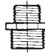
Штуцер редукционный с внешней резьбой.
