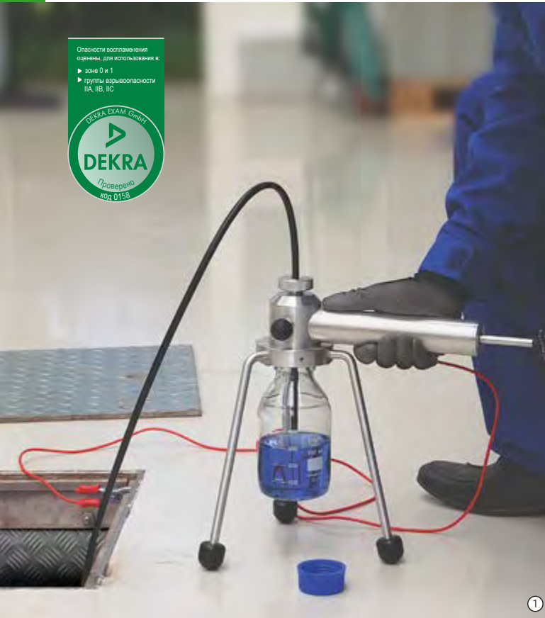
«ПрофиСамплер» (ProfiSampler), алюминий
