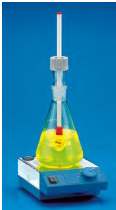
Поджимная силиконовая пробка
